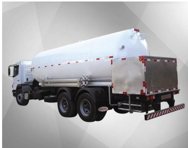
Figura 9: Tanques criogênicos móveis (Nitrotec).
